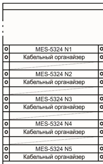
Рисунок 44 — Размещение коммутаторов MES5324 в стойке
